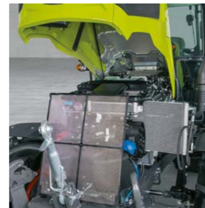
En un santiamén se puede sacar el radiador y retirar el tamiz del radiador para su control y limpieza.
