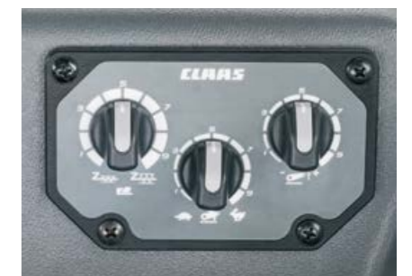
El ajuste de la fuerza de tiro, la velocidad de descenso y la limitación de la elevación los ajusta de forma confortable en la consola derecha.
