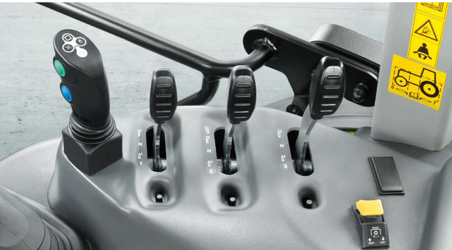
El caudal máximo del mando mecánico-hidráulico nr. 3 puede ser limitado con una manipulación en la cabina.
