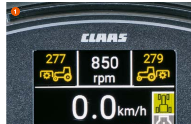
1 Gracias al indicador digital del régimen de revoluciones para la toma de fuerza delantera y trasera, siempre trabaja con el régimen de revoluciones adecuado.
