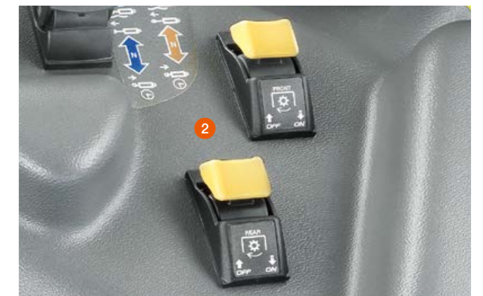
2 La toma de fuerza delantera y trasera se pueden activar fácilmente pulsando un botón.
