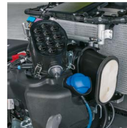
El filtro de aire PowerCore® está colocado ofreciendo un buen acceso, en el lado delantero, debajo del capó del motor, y reduce los intervalos de limpieza.
